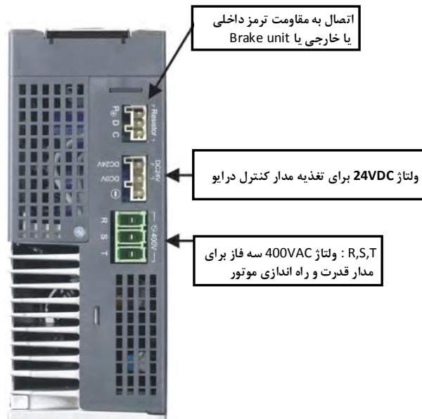
سوکتهای بالای درایو سری 400VAC
